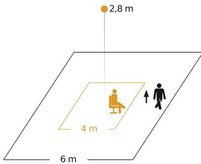
Possibile altezza di montaggio: 2,00 m - 5,00 m
